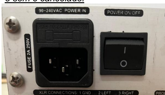
Detalhe do Painel traseiro – Tomada de Força e Chave Liga/Desliga.
